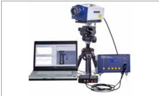
Hình 2. Máy laser đo dao động
